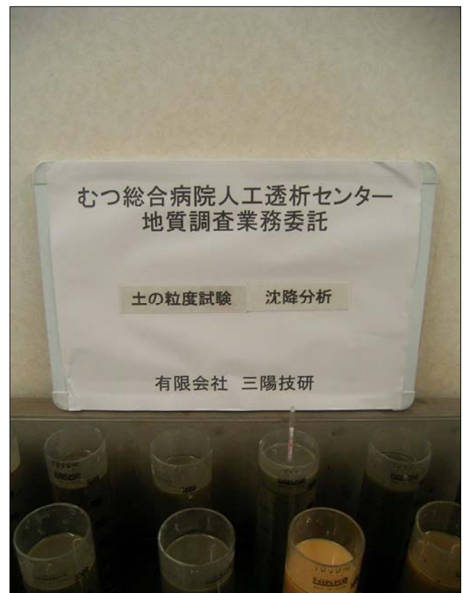
土 の 粒 度 試 験 ( 沈 降 )
