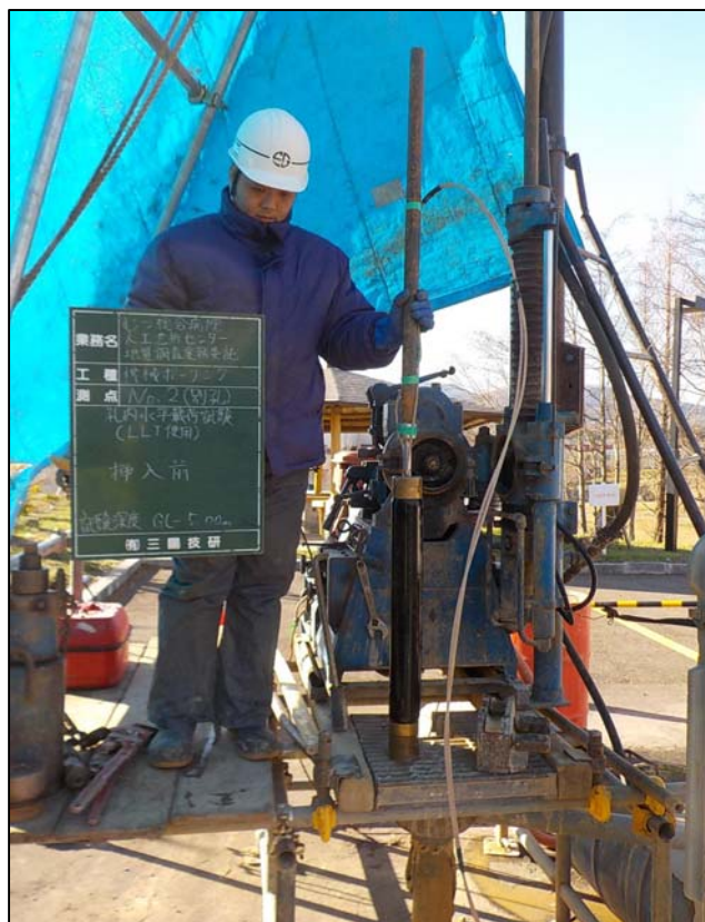
孔内水平載荷試験(LLT使用)挿入前
