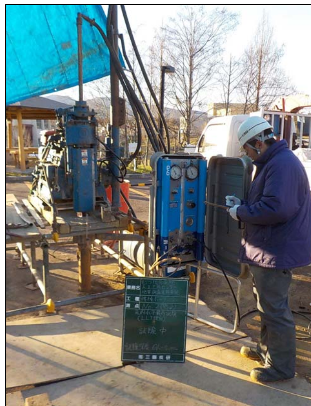
孔内水平載荷試験(LLT使用)試験中
