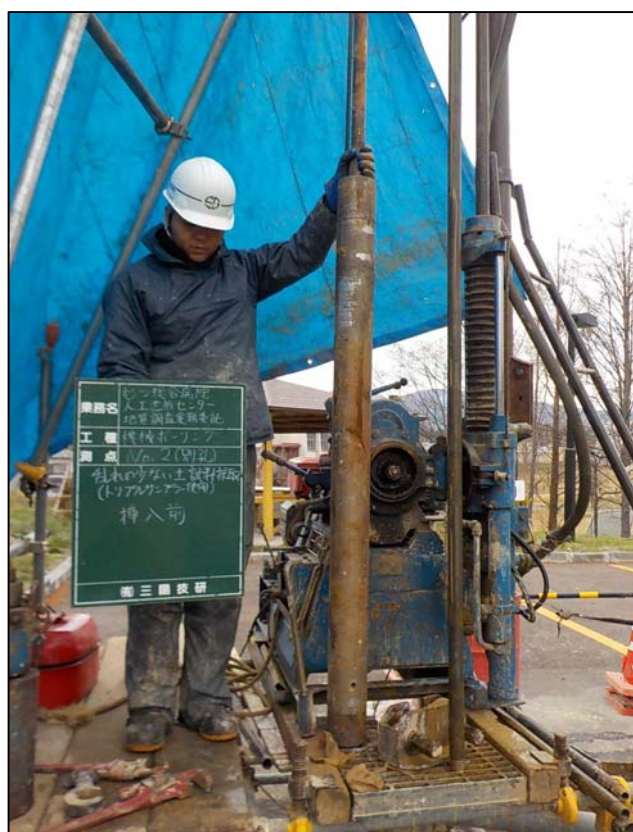
乱れの少ない土試料採取 (トリプルサンプラー使用)挿入前
