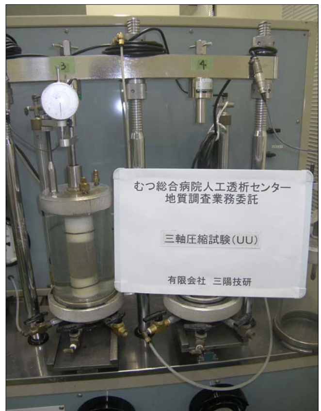
三 軸 圧 縮 試 験 (UU)
